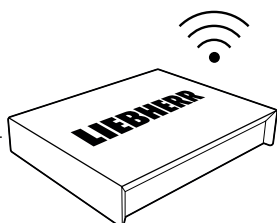
SmartCoolingHub Collecte de données et communication avec services Cloud
